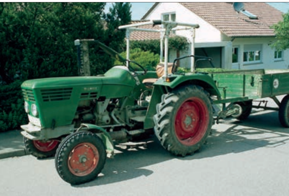
Die Einsteiger-Modelle mit den neuen 912er-Motoren waren der D2506 und D3006 mit zwei Zylindern.
