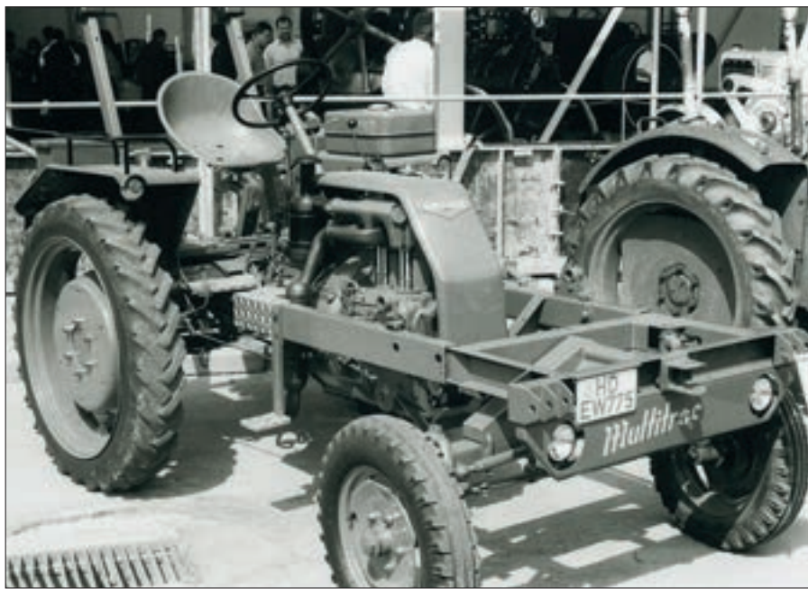
Zur Programmergänzung stand Ende der 50er-Jahre der Ritscher-Geräteträger, ausgerüstet mit Deutz-Motor, bei den Deutz-Händlern als »Deutz-Multitrac« in den Verkaufsräumen.
