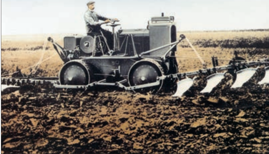
Bei der »Deutzer Pfluglokomotive« konnte dank doppeltem Führerstand und beidseitig angebautem Pflug auf das Wenden am Ackerende verzichtet werden. Allradantrieb und Allradlenkung vereinfachten das Fahren.
