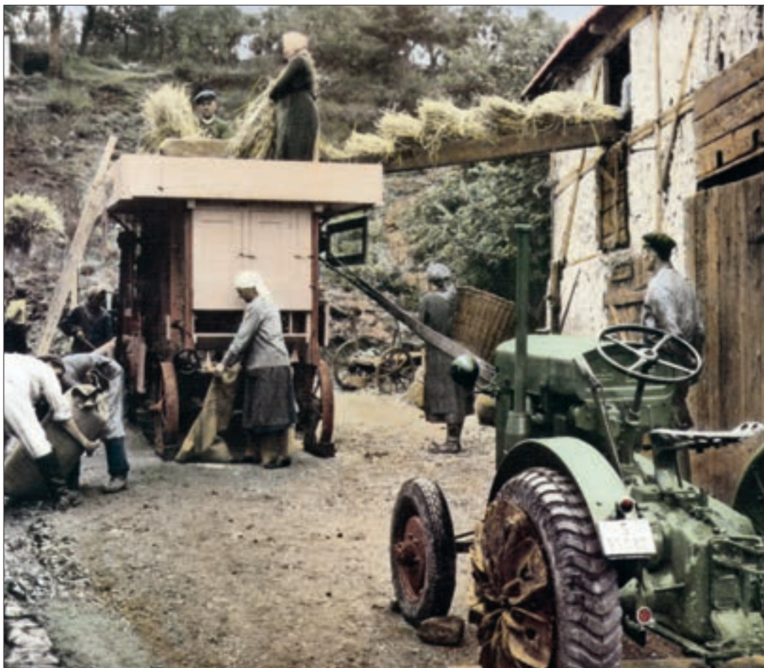
Einen wesentlichen Beitrag zur Motorisierung der kleinen und mittleren Betriebe leistete der ab 1936 gefertigte Deutz F1M414, der schlicht »Elfer-Deutz« oder »Bauern-Deutz« genannt wurde.
