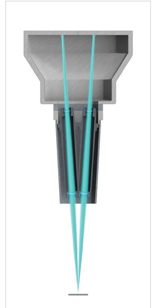
Prinzip Strahlengang eines Greenough-Stereomikroskops
