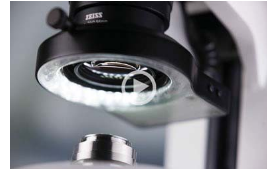
Das schattenfreie Ringlicht bietet vier verschiedene Modi: Voll-, Halb-, Viertelkreis oder 2 gegenüberliegende Viertelkreise. Schalten Sie das Ringlicht ein und drehen Sie dann die Lichtrichtung manuell in 90°-Schritten, um Kratzer, Defekte, Verunreinigungen oder Rückstände schnell zu erkennen, ohne Ihre Probe zu bewegen. Oder verwenden Sie den automatischen Rotationsmodus, um einen räumlichen Eindruck von der Objektoberfläche durch wechselnde Schatteneffekte zu erhalten.
