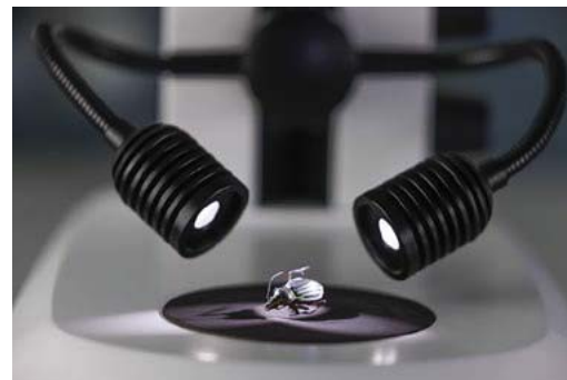
Für die Probenpräparation im Auflicht ist die Doppelspot-Beleuchtung mit selbsttragenden Schwanenhälsen optimal. Sie erzeugt Halbschatteneffekte, die einen guten 3D-Eindruck ohne allzu dunkle Schatten ermöglichen. Bei der Dissektion bleibt die Probe auch dann ausgeleuchtet, wenn die manipulierende Hand einen der Spots abdeckt.
