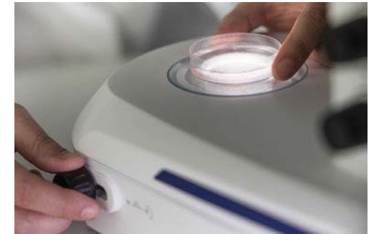
Die Durchlichtbasis mit Spiegel bietet Hellfeld-, einseitige Dunkelfeld- und Schräglichtbeleuchtung plus wahlweise Polarisationskontrast. Durch Drehen können Sie zwischen der satinierten und der regulären Spiegelseite wählen, und damit zwischen diffuser und kontrastreicher Hellfeldbeleuchtung.
