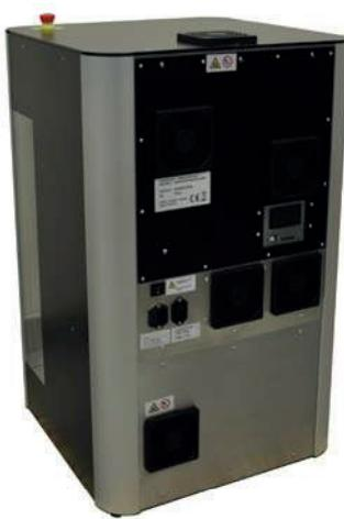
Die gesamte Leistungselektronik sowie die SPS befindet sich abgetrennt vom Arbeitsraum in einem separaten Schaltkasten der nach außen zwangsbelüftet ist. Das Heizgebläse befindet sich über den Flüssigkeiten und saugt von außen Frischluft an. Heizung, Arbeitsraum und Schaltschrank sind temperaturüberwacht. Eine Türüberwachung stoppt alle Achsen, wenn die Tür im laufenden Betrieb geöffnet wird.
